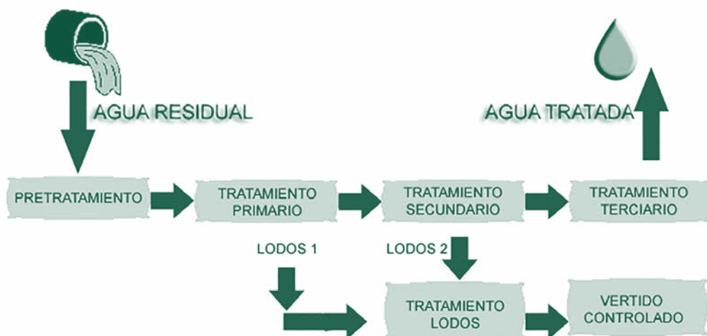
Figura No. 5.11. Diagrama de planta convencional de tratamiento de aguas residuales. Fuente: Amigos del Lago de Atitlán, 2017.
